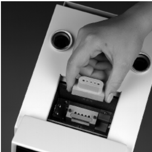
Bild 6: Einbau des Keramikoberteils
